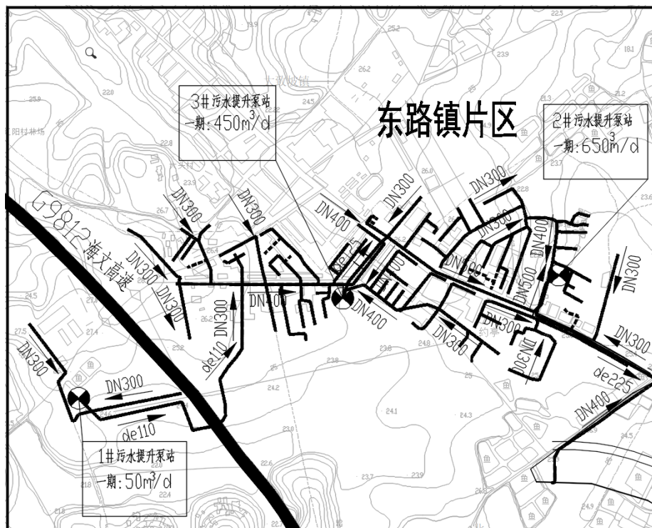
镇区排水管道及提升泵站现状图
